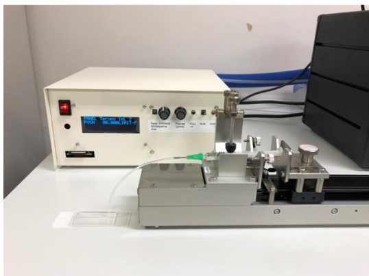
図1 シリンジポンプMFS-SP1(左)、Intensilightファイバー光源および顕微鏡(右)
